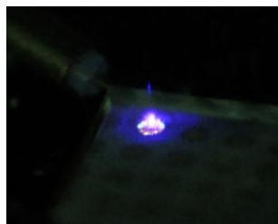
酸化亜鉛ナノ粒子塗布型発光ダイオードの発光の様子
